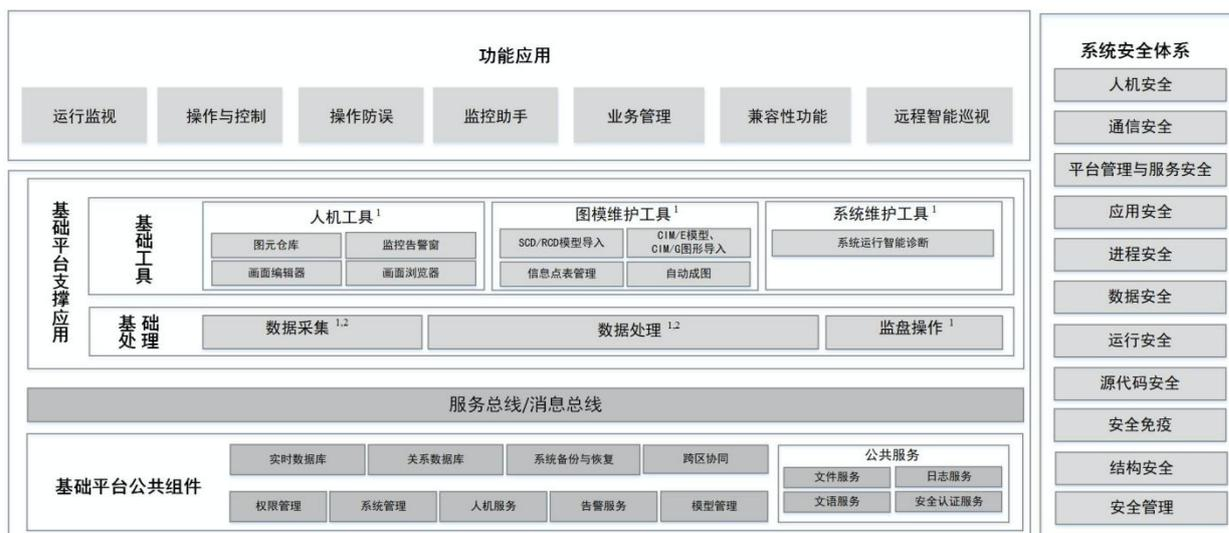
图 1 集控系统基础平台架构图
